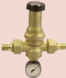
Редуктор давления<br>Диапазон регулирования 0,5 ... 6,0 бар,<br>температура 0...70 °С, Kvs - 3,5 м <sup>3</sup> /ч. | 15     | 16  | 1 2682 01    | 18        |  |
